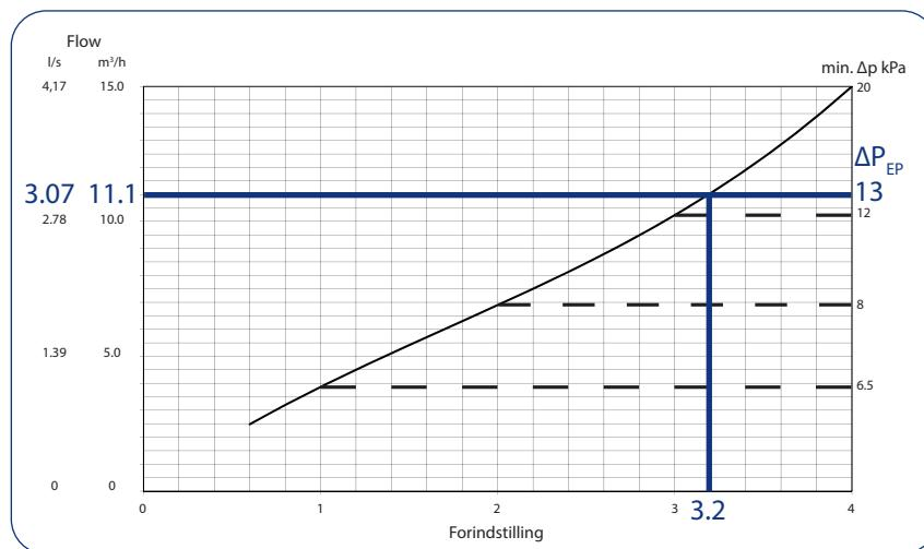
Den udvalgte Frese OPTIMA Compact EP DN50 LF kræver  $\Delta P_{EP} = 13$  kPa i differenstryk og skal forindstilles til 3,2 for at yde det nødvendige flow.
