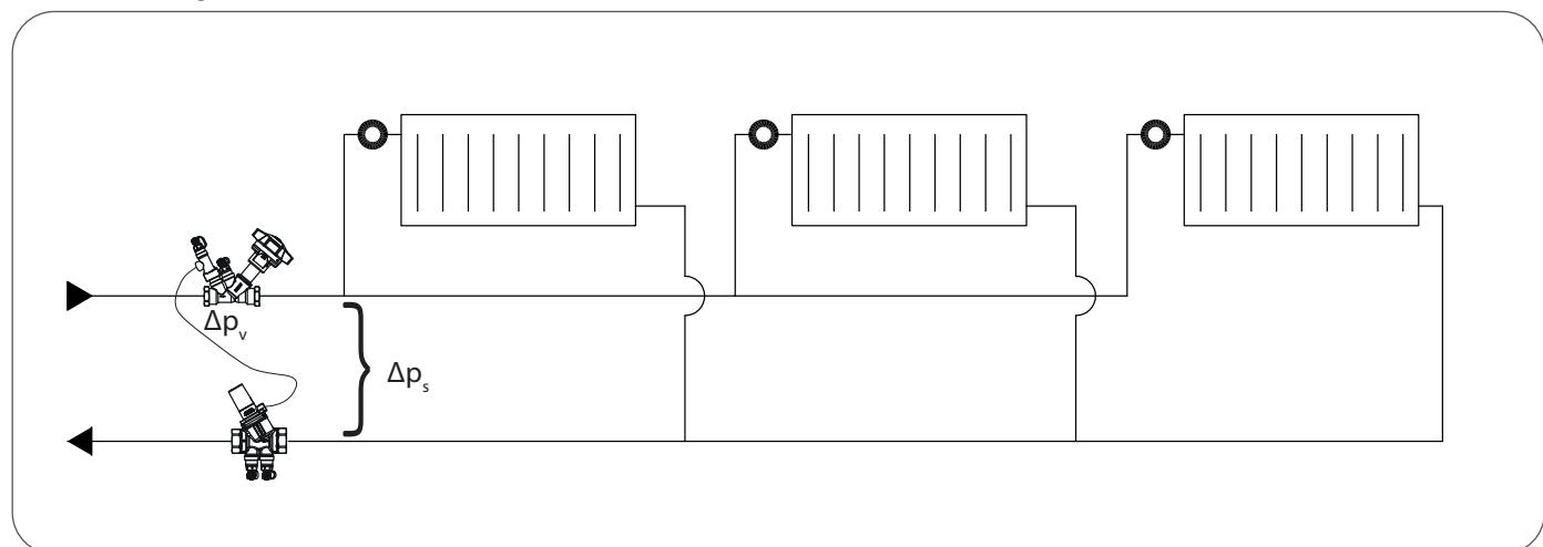
PV Compact installiert in einem Heizkörpersystem mit Frese STBV VODRV statischem Strangregulierventil. Die Lösung kann für Heizkörperventile mit oder ohne Voreinstellung verwendet werden.
