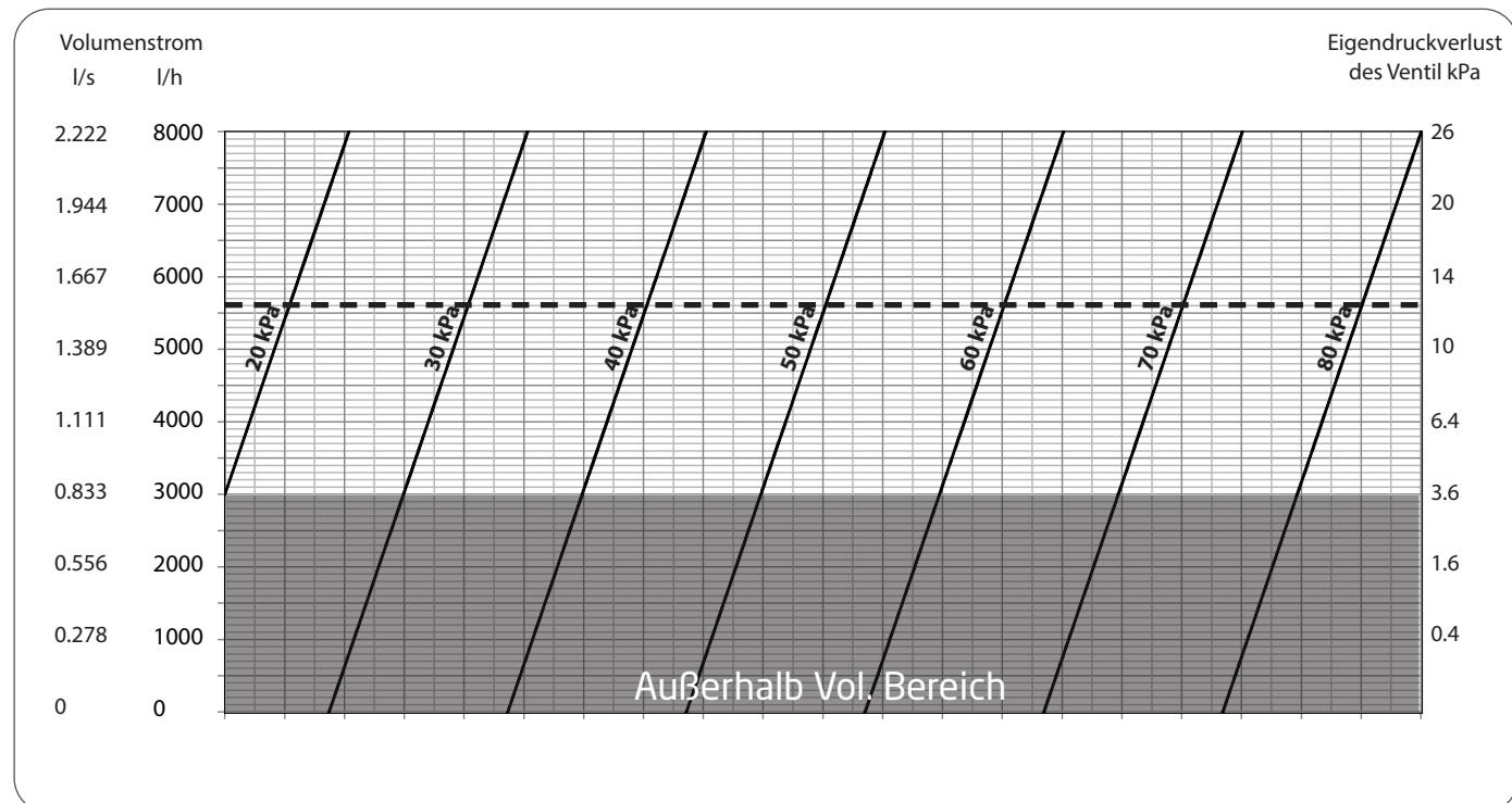
Volumenstromdiagramm · DN50, 20-80 kPa
