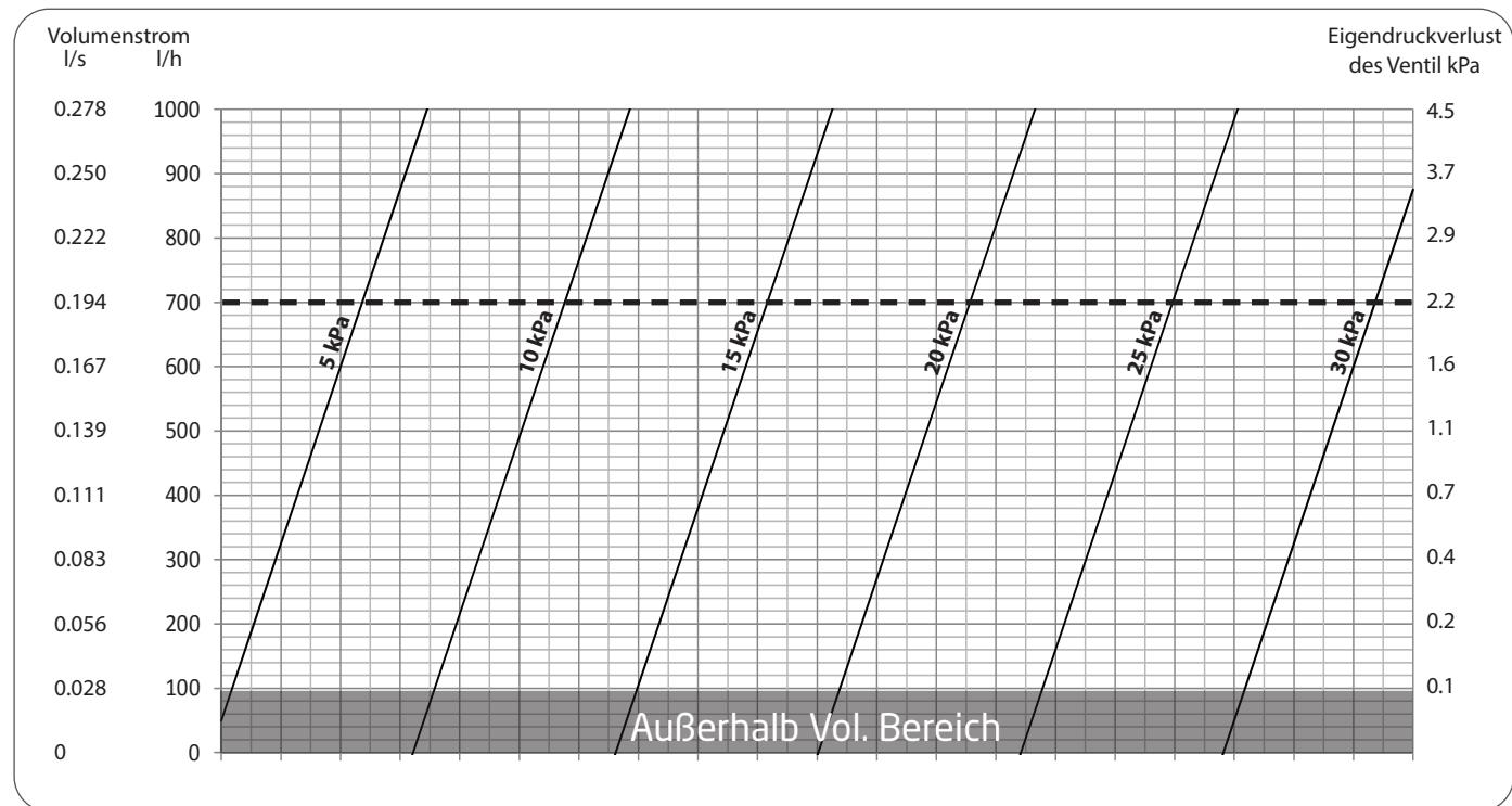
Volumenstromdiagramm · DN20, 20-60 kPa
