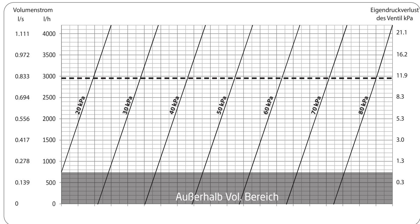
Volumenstromdiagramm · DN32, 20-80 kPa
