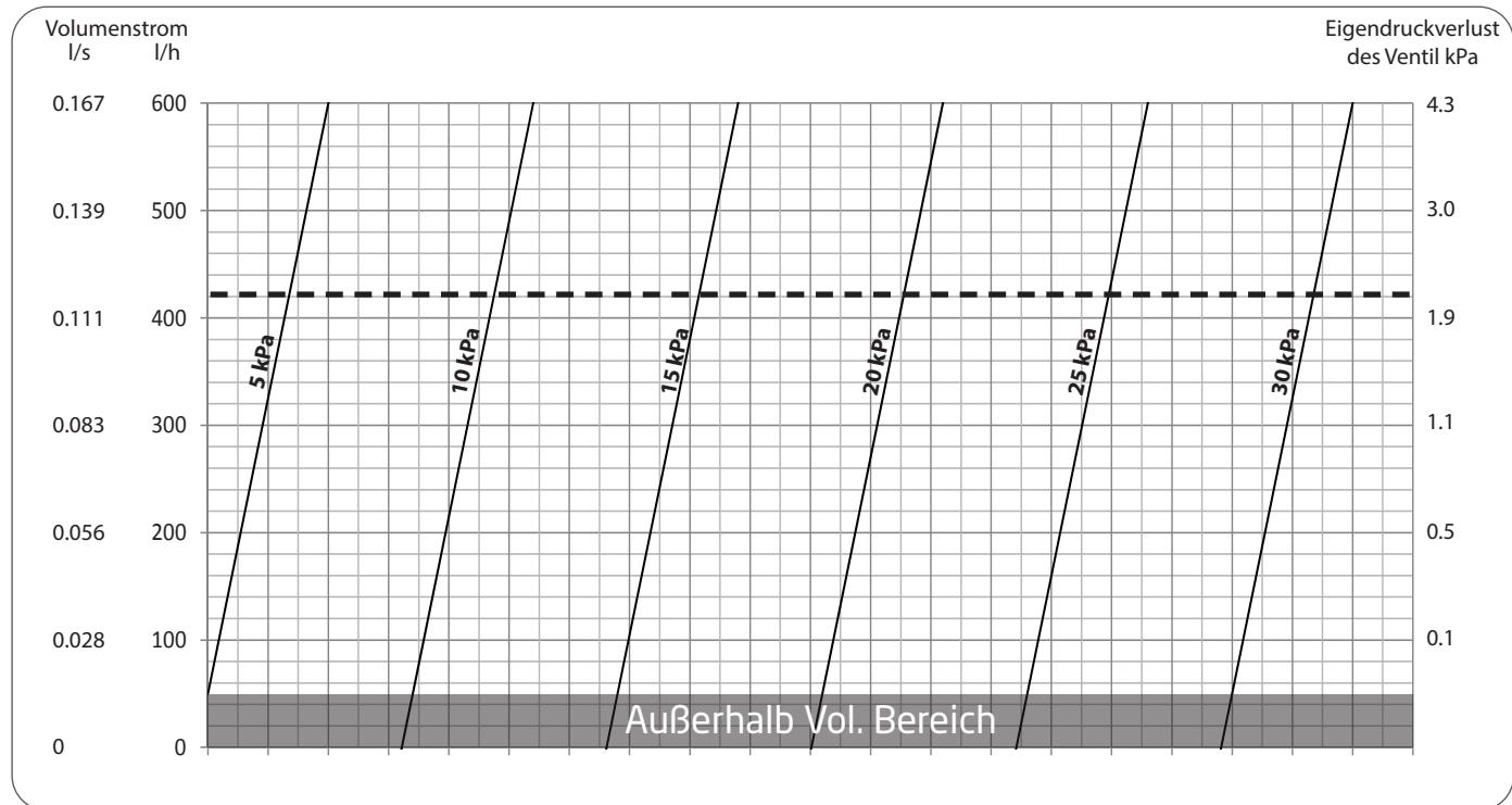
Volumenstromdiagramm · DN15, 20-60 kPa
