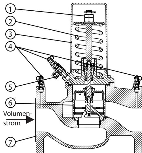
Durchschnitt des PV Compact DN50-DN200 mit 3 Druckmessnippeln
