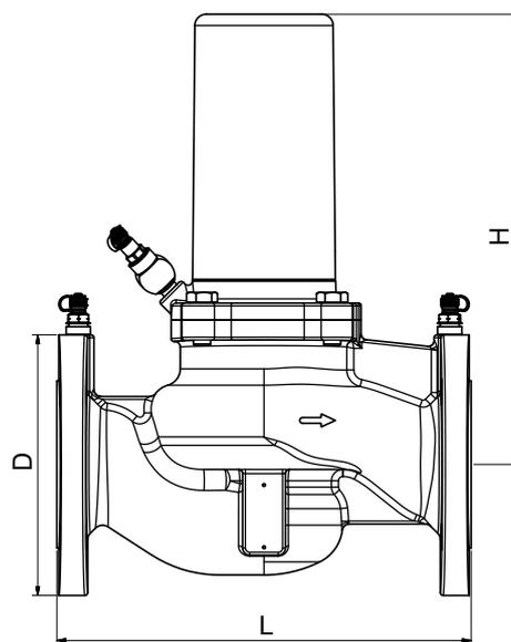
Durchschnitt des PV Compact DN50-DN200 mit 3 Druckmessnippeln
