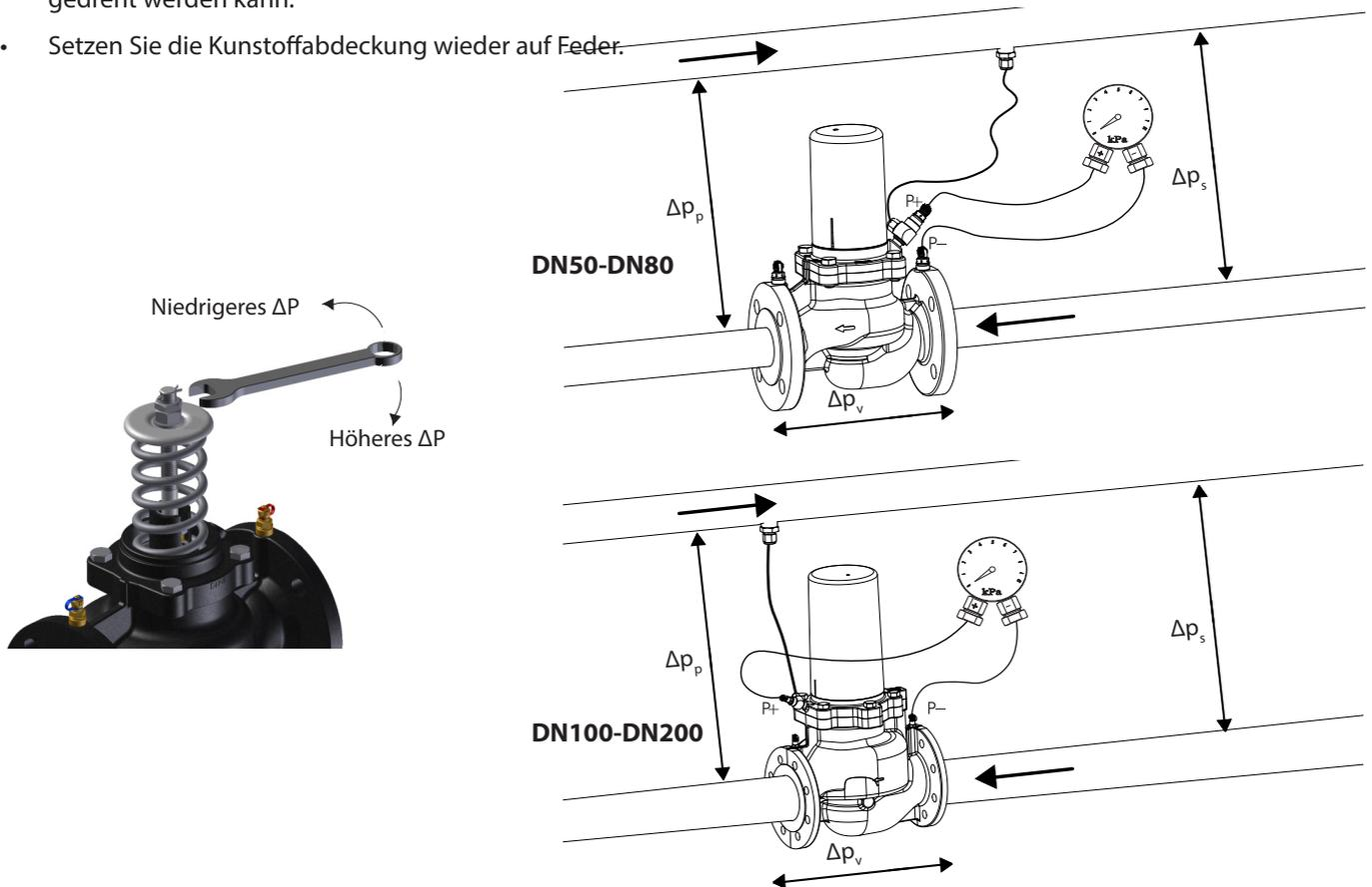
Das PV Compact muss im Rücklauf mit Kapillarrohr für den Anschluss zur Rohrleitung im Vorlauf installiert werden. In diesem Fall besteht der Zweck des Frese PV Compact darin, den Differenzdruck über die Vorlauf- und die Rücklaufleitung zu begrenzen.
