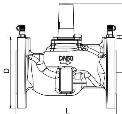
Durchschnitt des PV Compact DN50 mit 2 Druckmessnippeln
