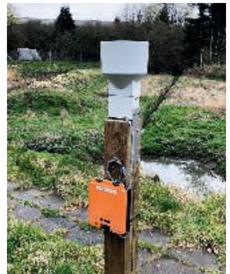
Wasys A/S har udviklet deres Gekko-datalogger til Sigfox IoT. Den kan kombineres med forskellige sensorer – f.eks. en regnmåler som vist på billedet, regnmåler Professional. GEKKO-datalogger enheden opsamlers og logger data og sender disse via Sigfox nettet til den valgte IT platform. Regnmålerløsningen kan kobles på alle standard styringer og PLC'er.
