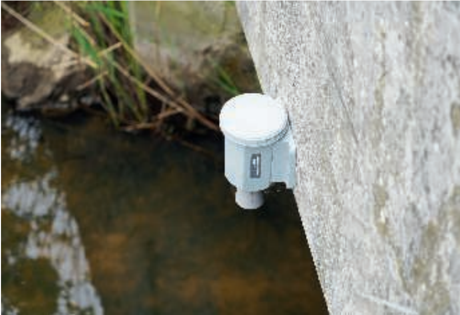
HedeDanmark har bl.a. udviklet en Sigfox IoT løsning til måling af overfladevand, som giver viden om vandstanden i åer, vandløb, regnvandsbassiner. Data præsenteres gennem HedeDanmarks IT portal eller integreres via API til kundens egne IT løsninger.
