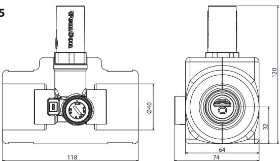
(DK) **FIG 5:** TemCon leveres inkl. isoleringskappe, som skal monteres for korrekt funktion. Indbygningsmål er som angivet. Med aktuator påmonteret vil bredden være 115 mm.
