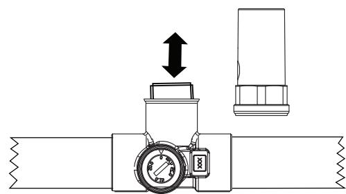
(DK) **FIG 6:** Det er muligt at motionere TemCon ventilen manuelt. Afmontér blot ventilenstopdæksel og tryk ekspansionscylinderen ned et par gange. Det er ikke nødvendigt at afspærre strengen for at betjene ventilen.
